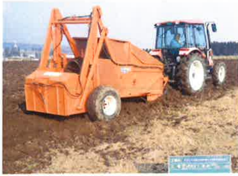
ストーンピッカーによる小径石礫の除去
